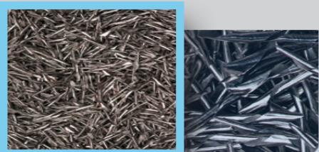
Длинная стружка при использовании обычного инструмента.
